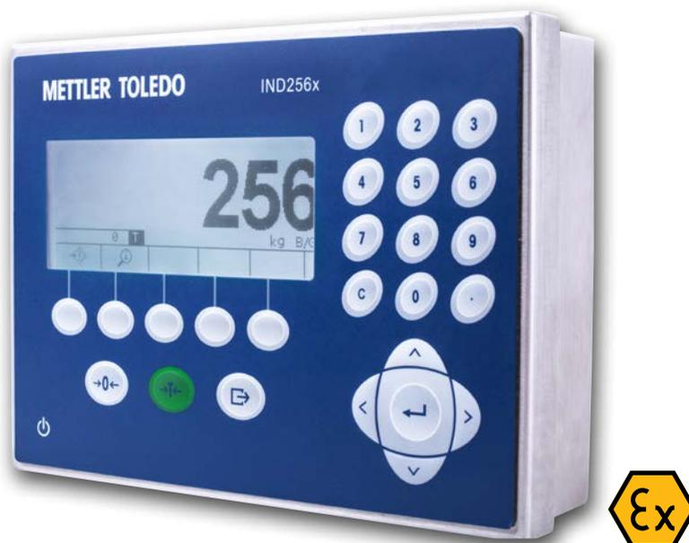
IND256x仪表是一款可以胜任在危险气体和粉尘的危险1/21区使用的防爆称重仪表，产品设计完全满足最新的防爆法规要求，主要采用本质安全型防爆设计，提供各种本安型通信接口，可以组成性价比较高的称重系统，提供安全、稳定、灵活的称重解决方案。
