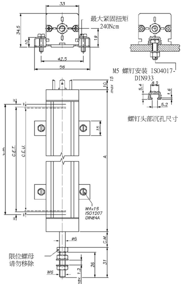
重要提示：产品说明中包括线性度、使用寿命、温度系数在内的所有数据均为传感器正常使用参数，游标允许通过的最大电流不得超过 0.1 μA。
